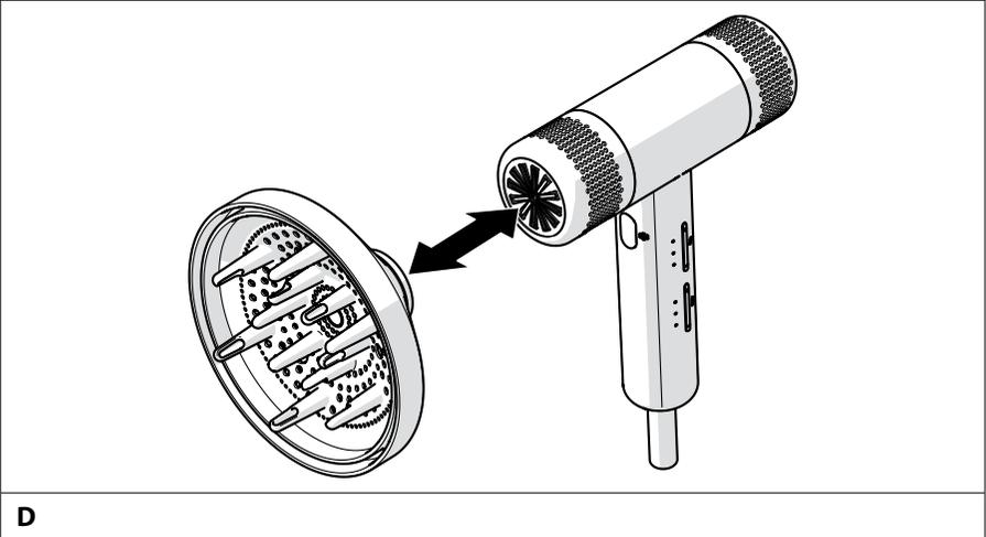
3. Bringen Sie die **Ondulierdüse** 7 oder den **Softstyler** 6 an der Vorderseite des Geräts an (siehe Abbildung D). Der **Softstyler** 6 ist als Zubehör erhältlich.
