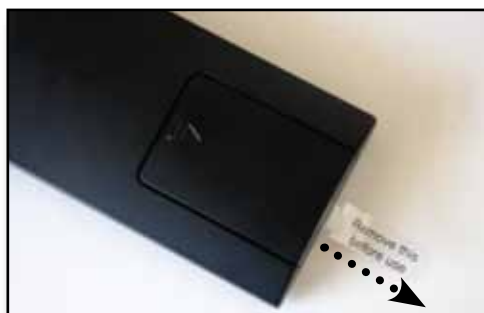
Abb. Rückseite Fernbedienung (Batteriefach) Zum aktivieren der Batterie die Lasche nach hinten wegziehen.
